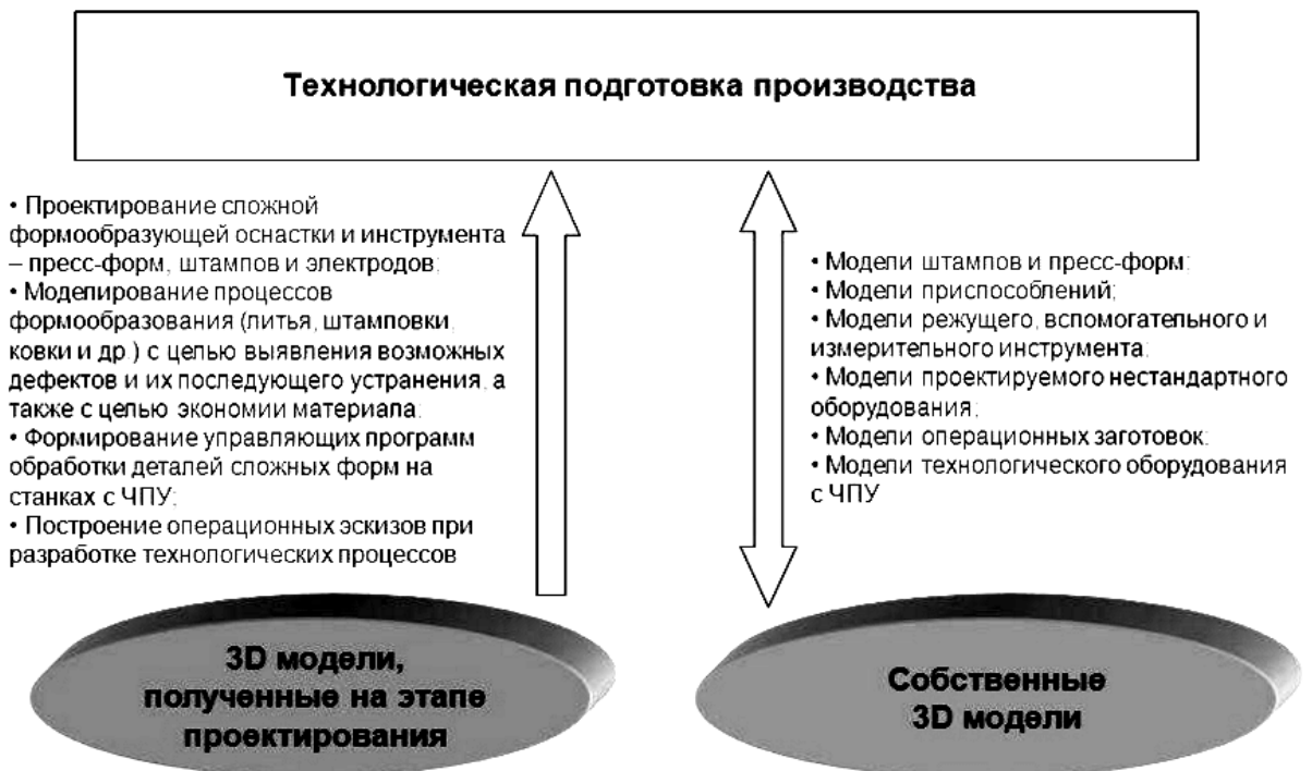
Рисунок 6.4 – Система автоматизированной логистики на этапе технологической подготовки производства
