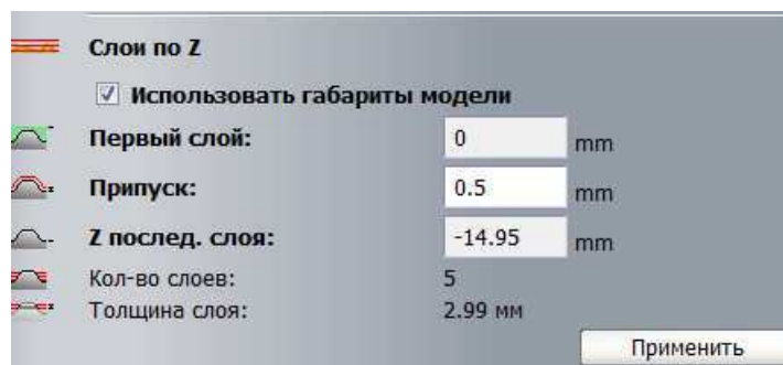
Рис. 5.8 – Расчёт числа проходов фрезы
