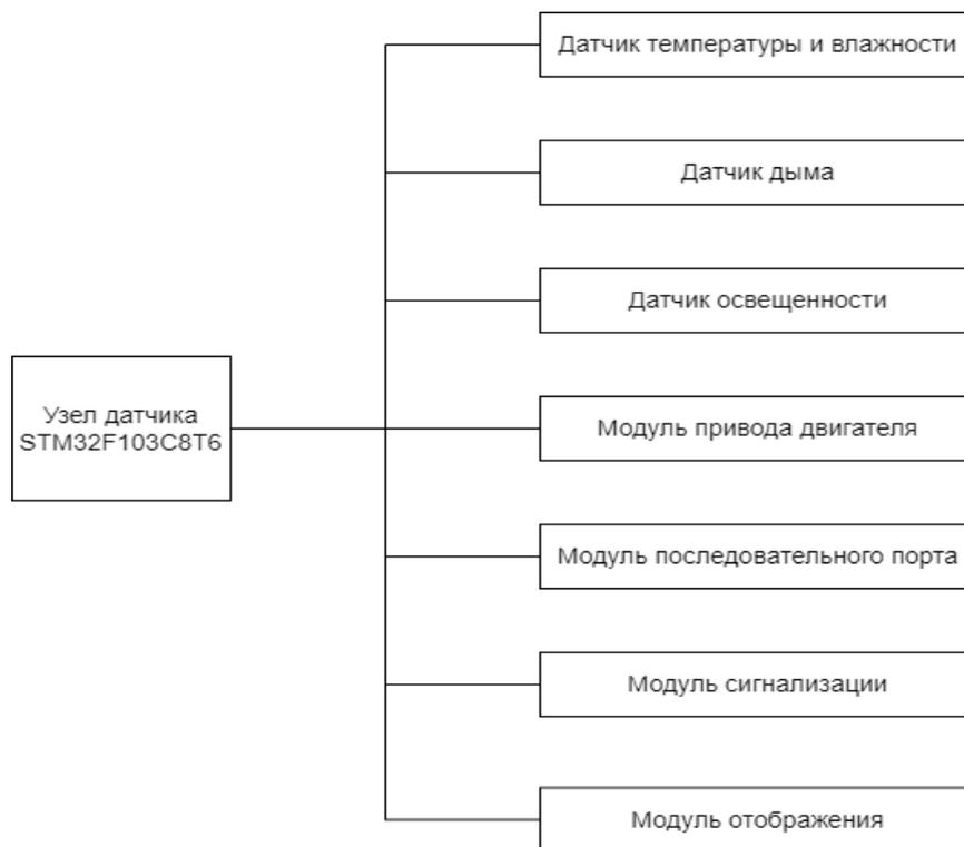
Рисунок 19 – Блок-схема конструкции оборудования
