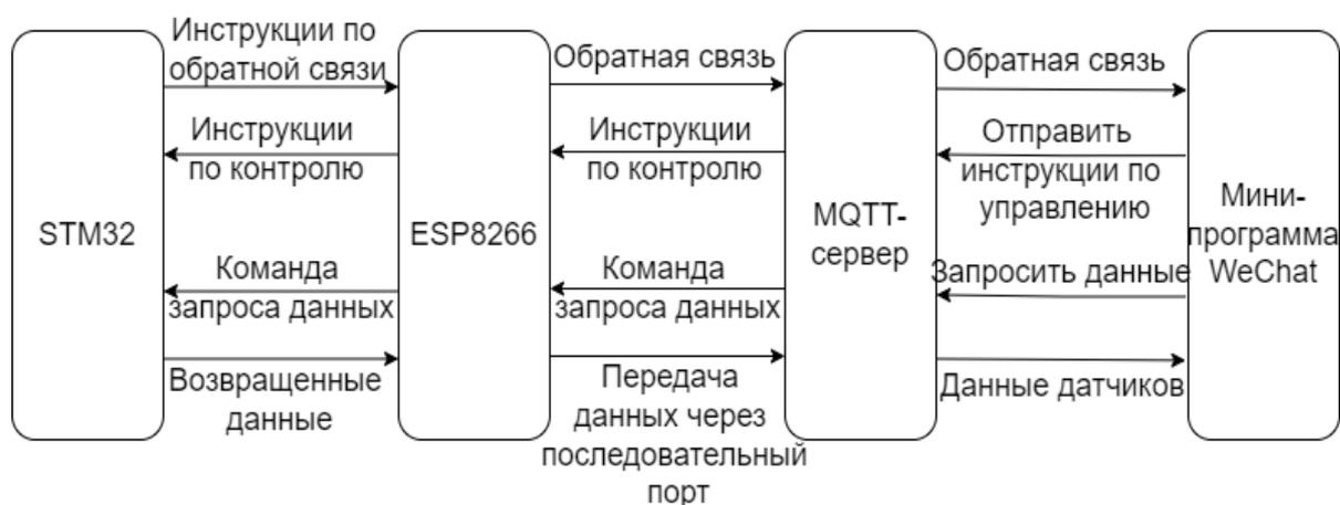
Рисунок 26 – Схема структуры принципа связи
