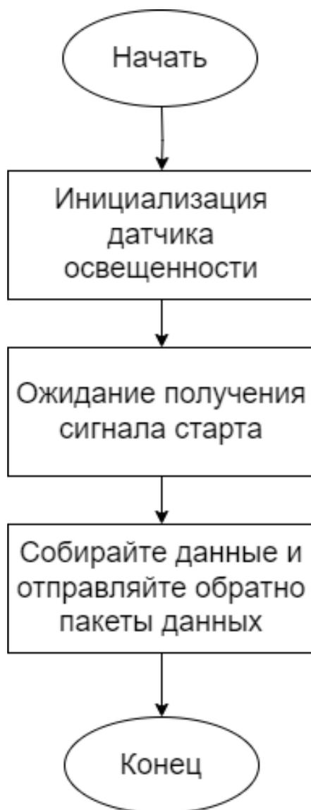
Рисунок 10 – Блок-схема сбора данных модуля фотодатчика BH1750
