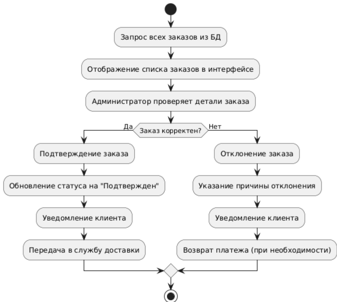
Рисунок 18 – Блок-схема рассмотрения заказа администратором
