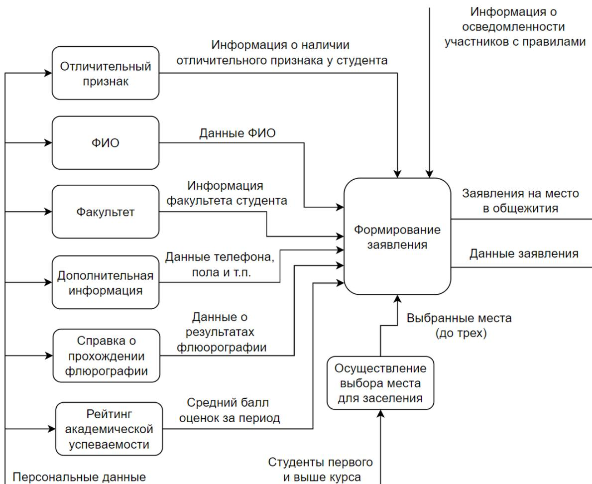
Рисунок 4 – Декомпозиция модуля «Подача заявления»
