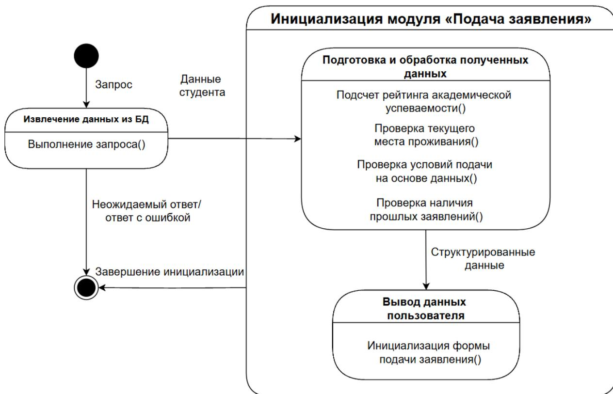
Рисунок 24 – Диаграмма состояний процесса инициализации модуля подачи заявления
