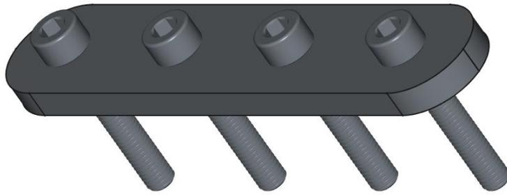
Рисунок 17 - 3D модель фиксирующего устройства
