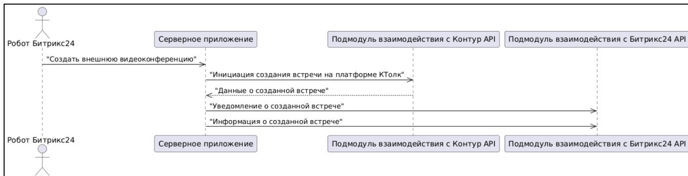
Рисунок 2.6 – UML-диаграмма последовательностей, показывающая взаимодействие сервисов модуля интеграции при создании внешней встречи
