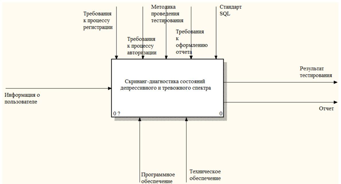
Рисунок 5 – Диаграмма взаимодействия функциональных подсистем
