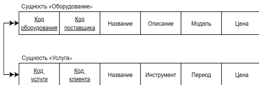
Рисунок 20 – Связь «Оборудование – Услуга»
