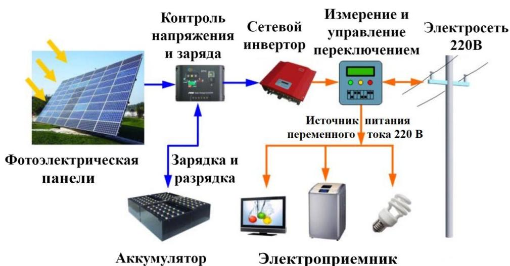
Рисунок 2.6 Распределенная система фотоэлектрической генерации, подключенная к сети
