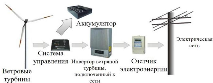
Рисунок 2.10 Схема подключения ветряной турбины к сети
