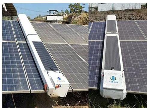
Рисунок 2.8 Самоходный робот для очистки фотоэлектрических панелей
