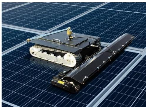
Рисунок 2.7 Гусеничный робот для очистки фотоэлектрических панелей
