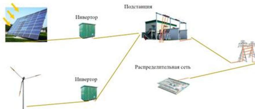
Рисунок 3.2 Подключение фотоэлектрических и ветровых источников к электрическим сетям
