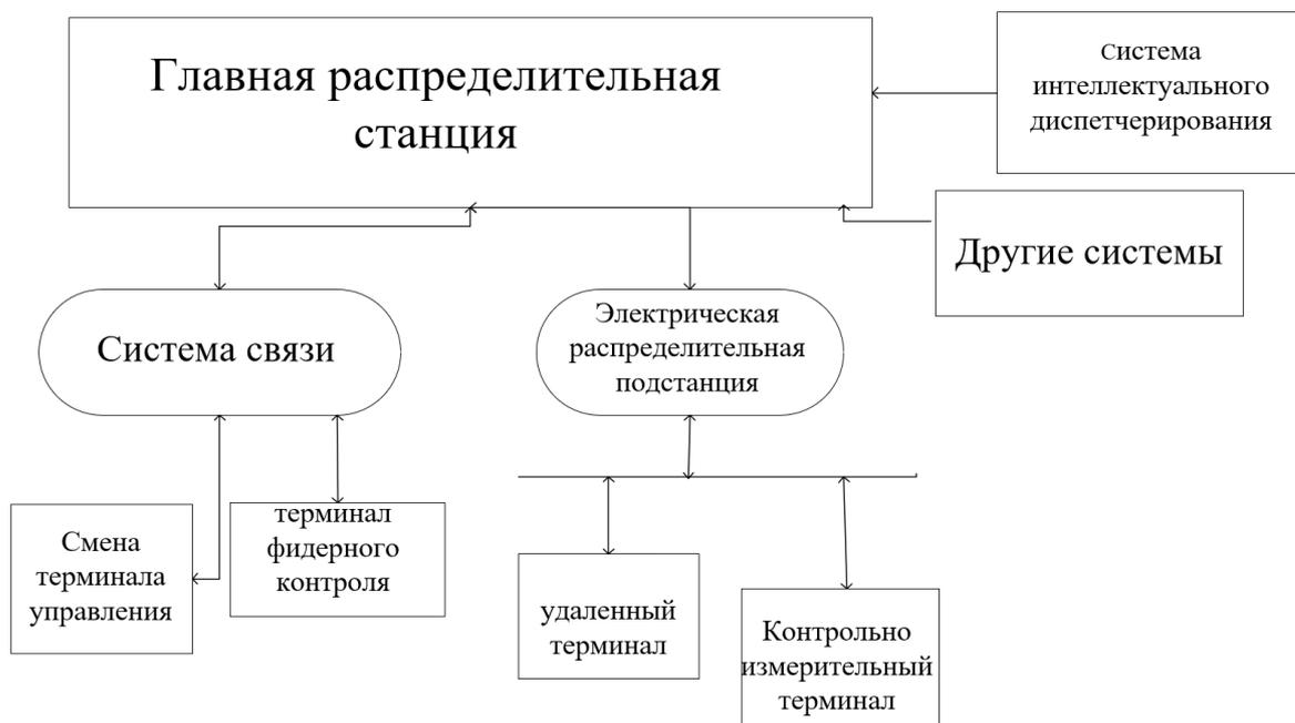
Рис 2-1 блок - схема системы автоматизации распределительной сети
