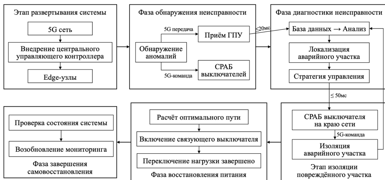
Рис. 3-4. Блок-схема быстрой защиты и самовосстановления распределительной сети на основе связи 5G
