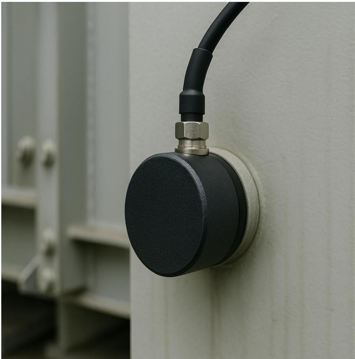
Рисунок 8 – Пример применения пьезоэлектрического акустического эмиссионного датчика, прикреплённого к боковой стенке трансформатора
