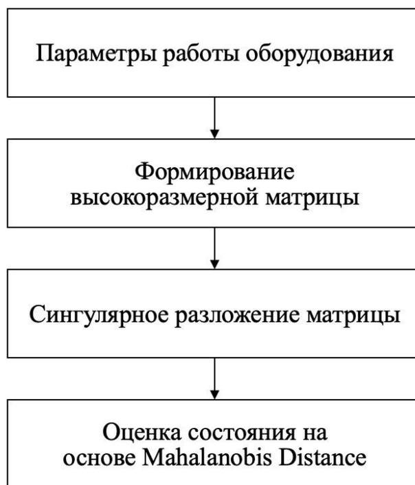
Рисунок 1 - Блок-схема оценки состояния случайной матрицы высокой размерности
