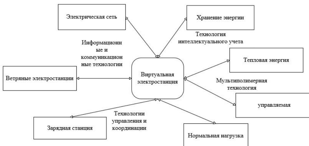
Рисунок 3-6 Схематическая диаграмма услуг, предоставляемых виртуальными электростанциями
