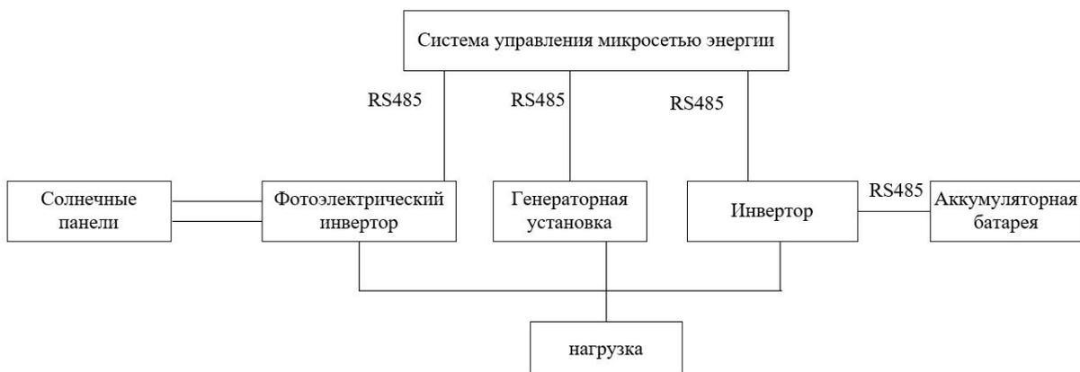
Рисунок 4-3 Топология архитектуры распределенного совместного управления
