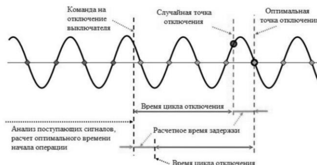
Рисунок 9 – Работа выключателя в управляемом и неуправляемом режиме
