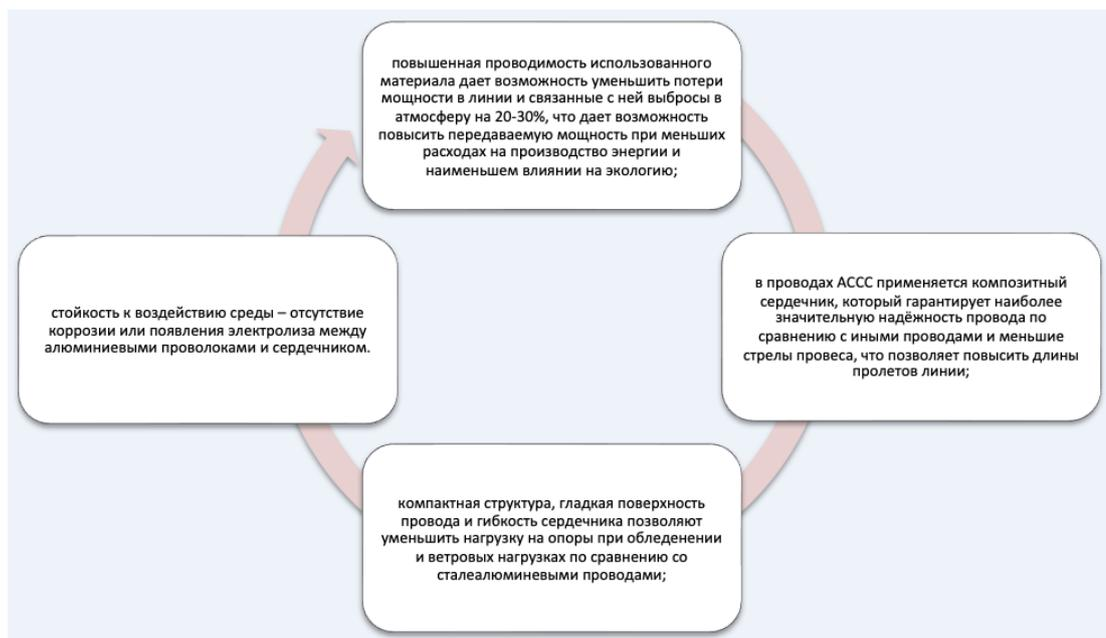
Рисунок 2.2 – Схема экономической выгоды при эксплуатации провода АССС
