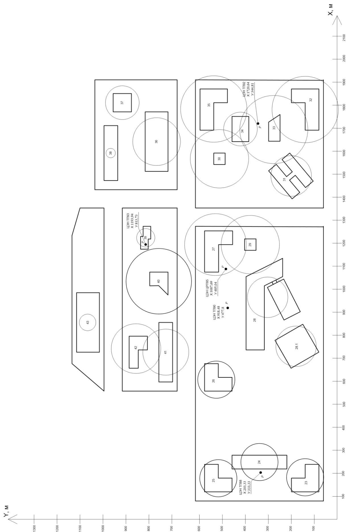
Рисунок 7 – Картограмма центров энергетической нагрузки
