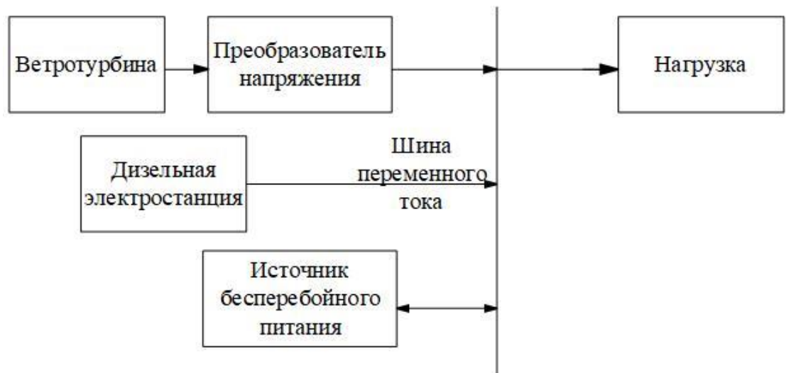
Рисунок 2 – Установка ВЭС с дизельной электростанцией
