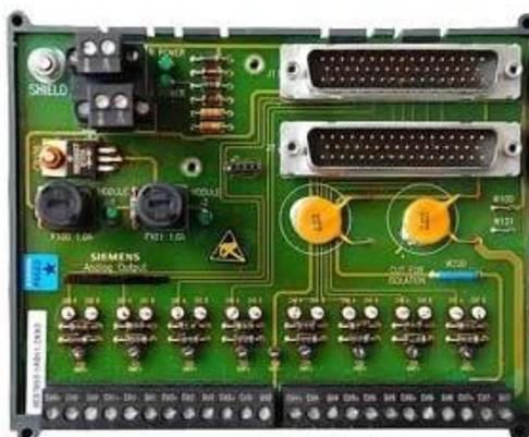
Рисунок 16 – Терминальный модуль Siemens 6ES7650-1АН62-5ХХ0
