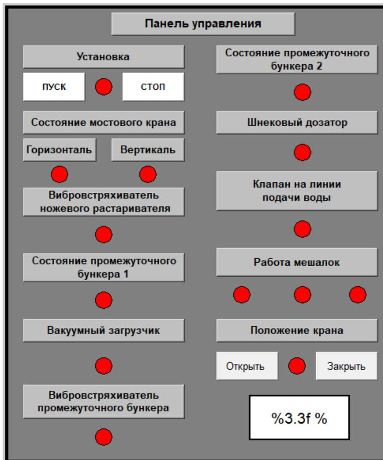
Рисунок 19 – Панель управления установкой приготовления флокулянта
