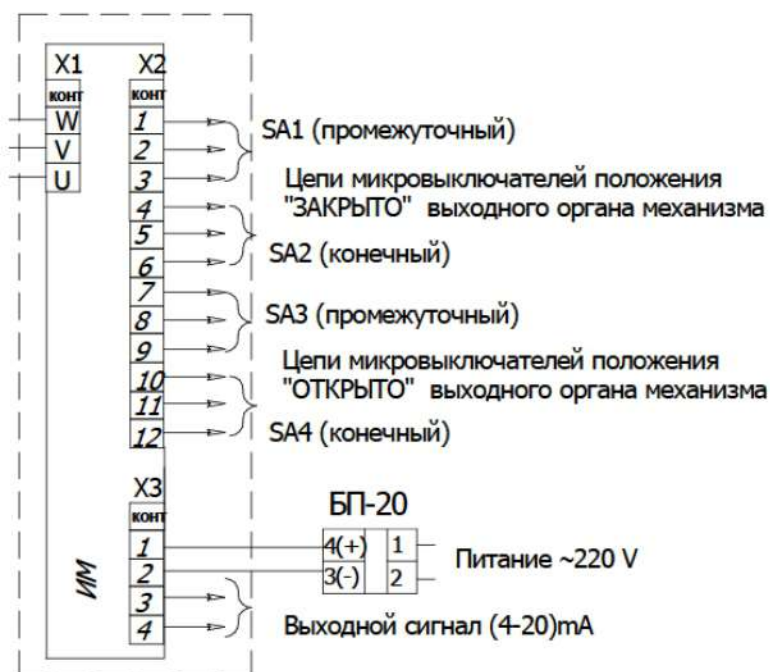
Рисунок 2.7 – Схема подключения МЭОФ-260
