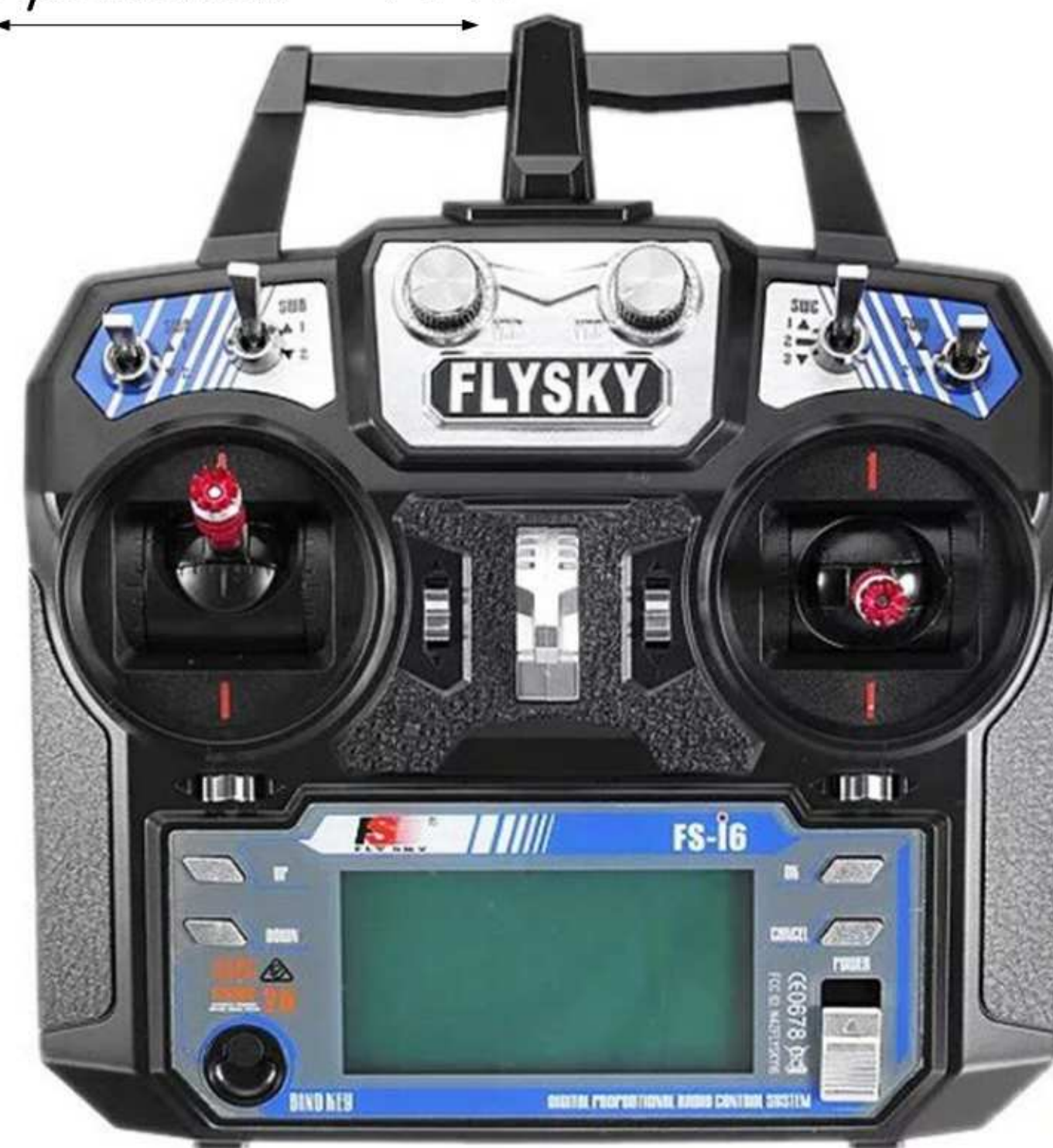
Пульт для управления мобильным роботом
