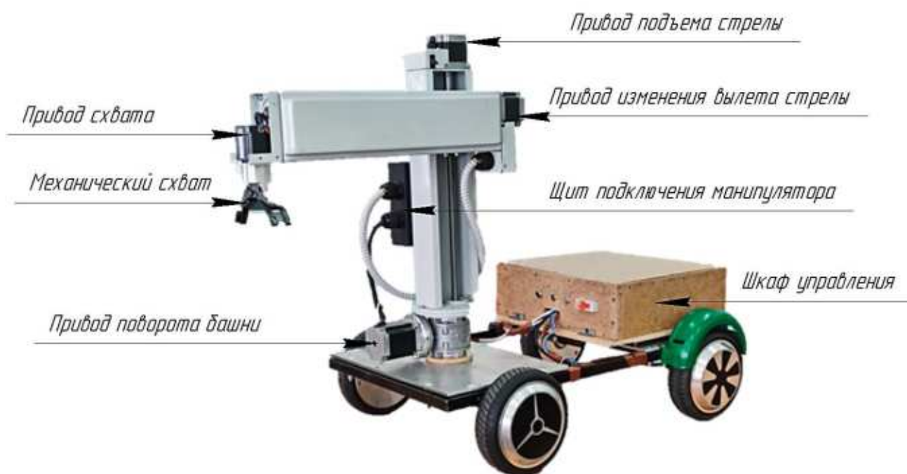
Рисунок 1.1 – Внешний вид мобильного робота – манипулятора
