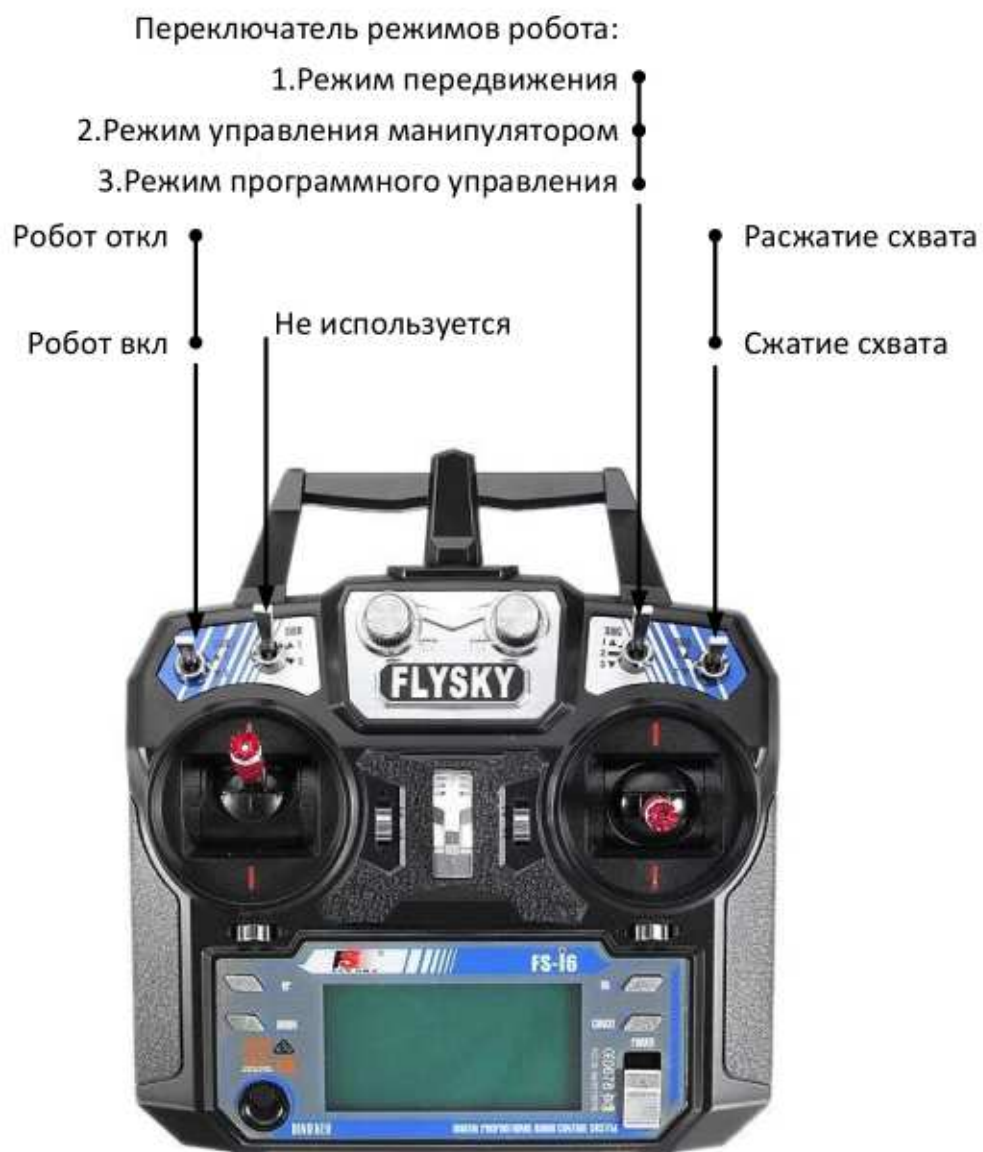
Рисунок 3.10 – Назначение переключателей на RC-пульте
