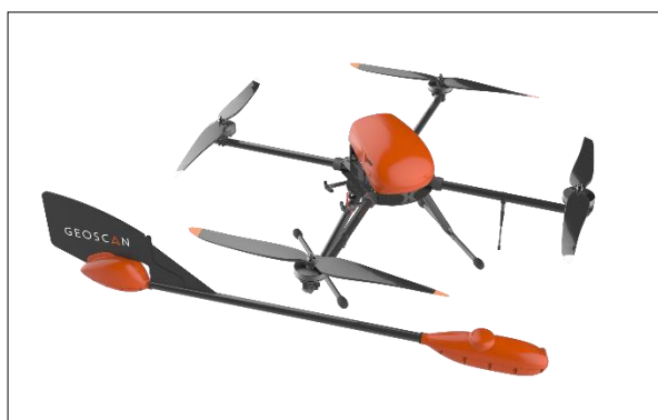
Рисунок 6 - Беспилотный летательный аппарат – квадрокоптер «Геоскан 401» и квантовый магнитометр Geoscan QM-Rb
