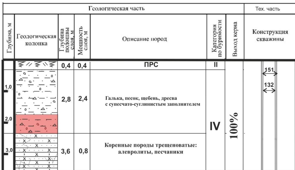
Рисунок 2 – Конструкция проектируемых скважин
