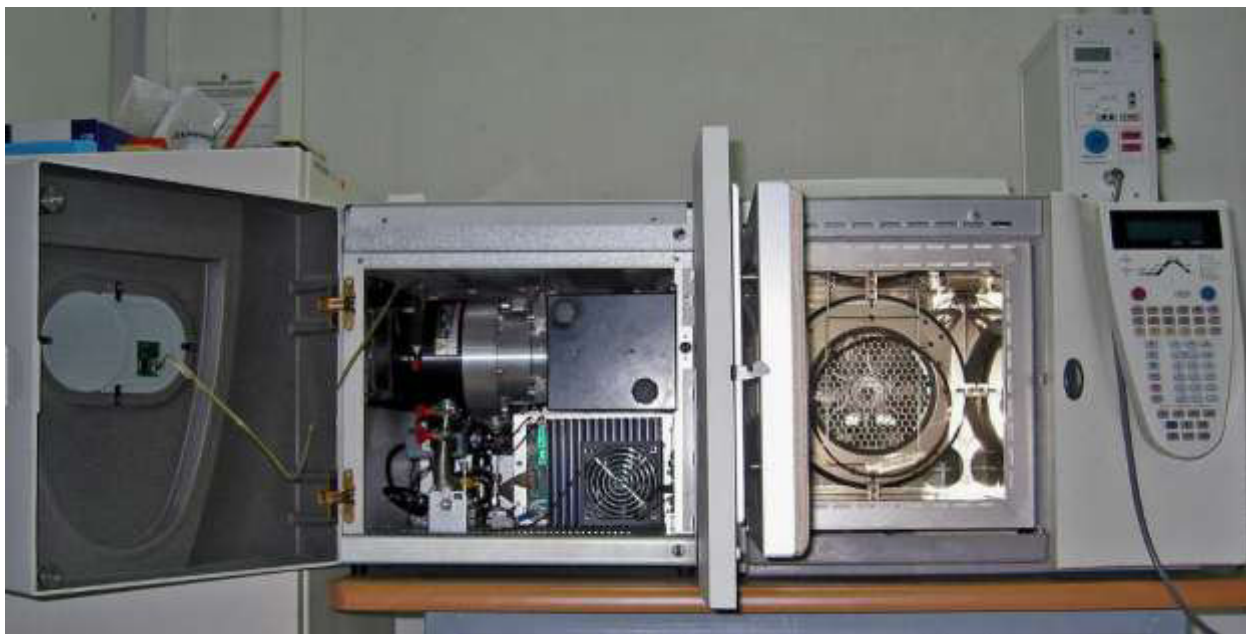
Рисунок 4 31 – Пример газоанализатора, работающий по методу газовой хроматографии
