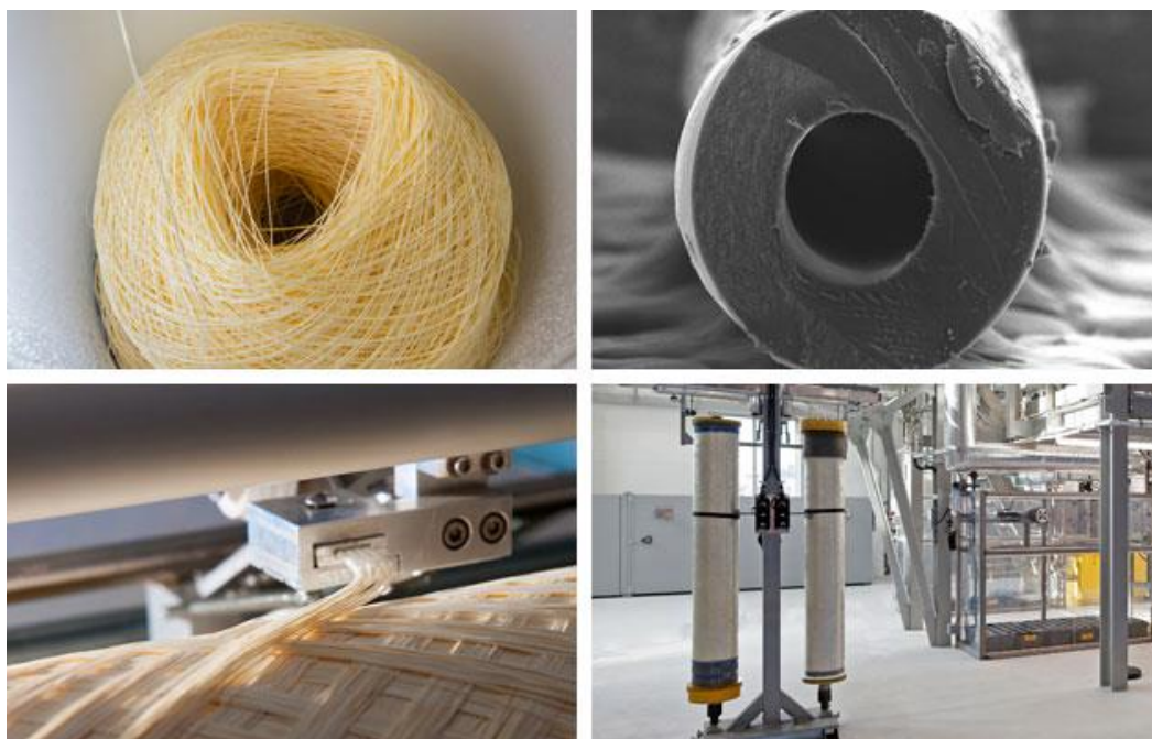
Рисунок 2 – Полимерная мембрана для разделения газовых смесей
