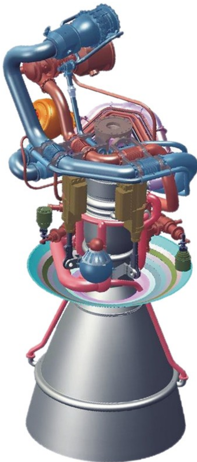
Рисунок Б.1 – Метановый многоразовый жидкостный ракетный двигатель РД0162
