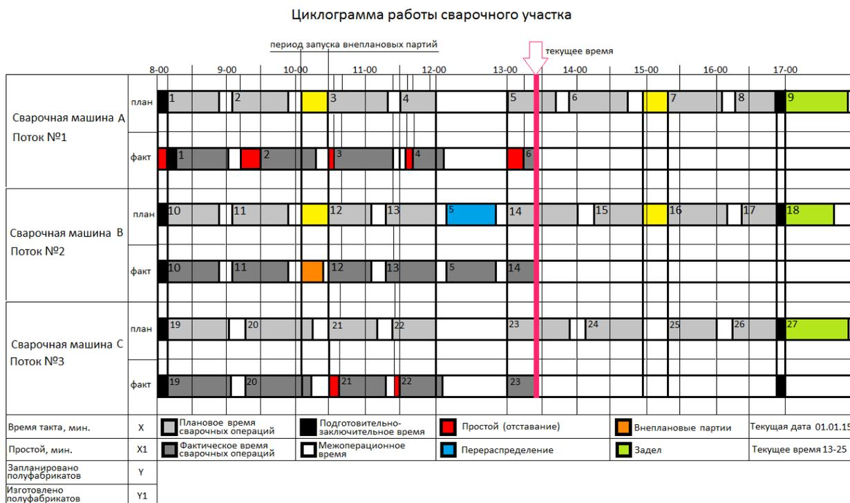
Рисунок 15 — Принципиальная схема циклограммы
