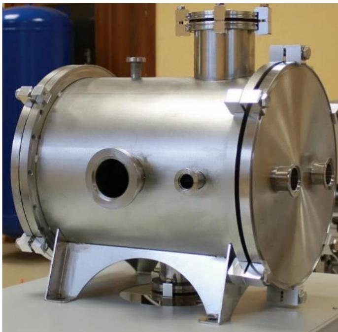
Рисунок 3 — Общий вид вакуумной камеры
