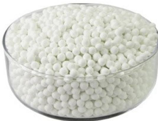
Рисунок 11 – Гранулированный синтетический цеолит NaX
