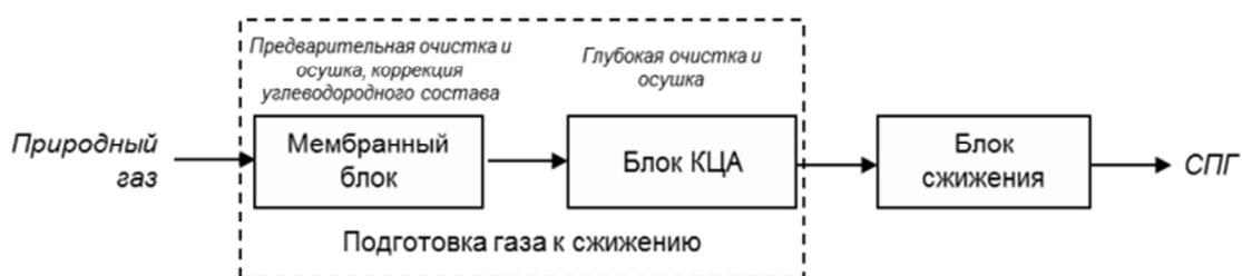
Рисунок 1 – Схема очистки природного газа
