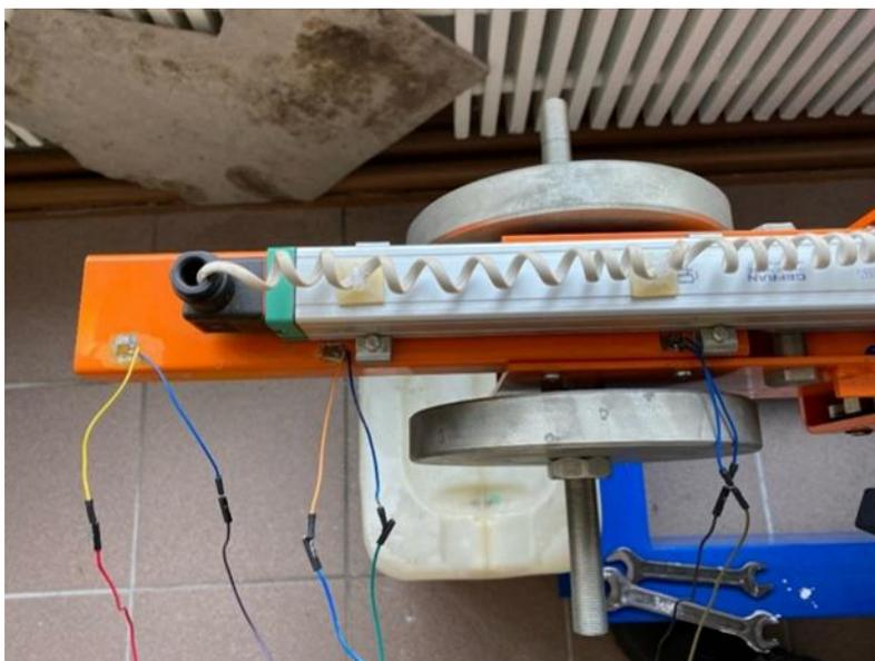
Рисунок 22 – Установка тензорезисторов на модуль подъемного механизма СГУ-АТРГ-ГПМ
