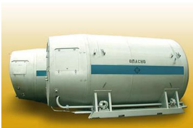
Рисунок 2.5 – Цистерна типа ЦТК-5/0,25
