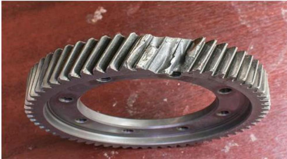
Рисунок 1.3 – Излом зубьев
