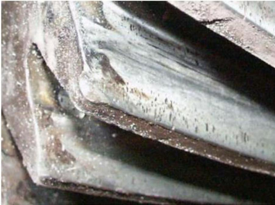
Рисунок 1.4 – Усталостное выкрашивание рабочих поверхностей зубьев
