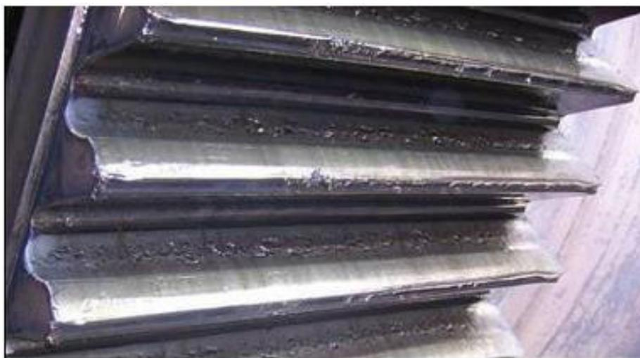
Рисунок 1.5 – Изнашивание зубьев
