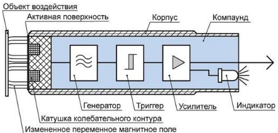
Рисунок 4 – Структура индуктивного датчика [7]
