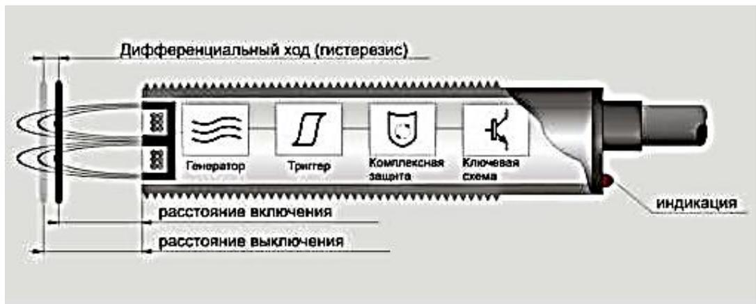
Рисунок 5 – Структура индуктивного датчика [7]
