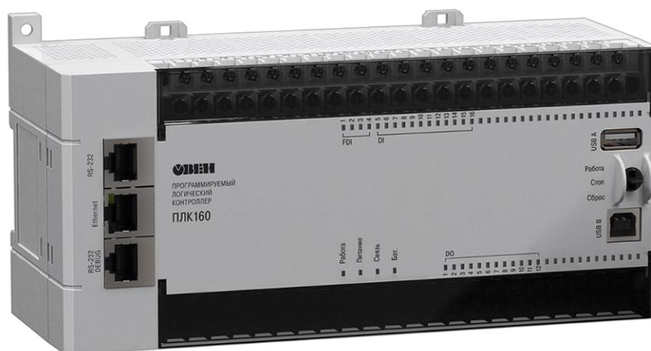
Рисунок 18 – Контроллер ОВЕН ПЛК160 [14]
