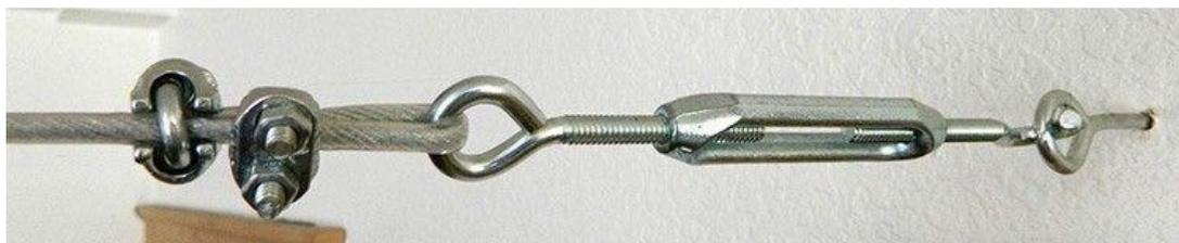
Рисунок 1 – Винтовой натяжитель
