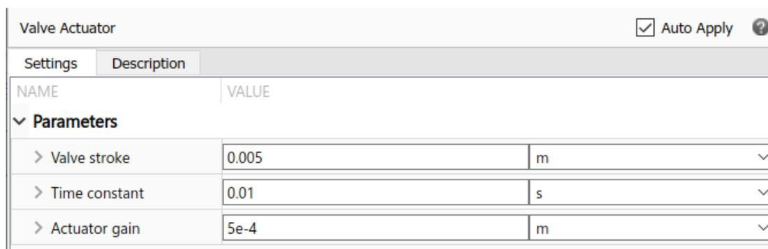
Рисунок 2.9 – Окно настроек блока Valve Actuator
