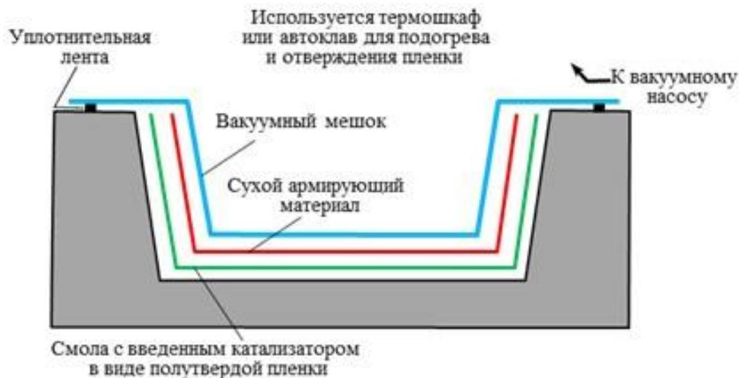
Рисунок 8 – Изображение схемы процесса получения изделий методом пропитки плёночным связующим
