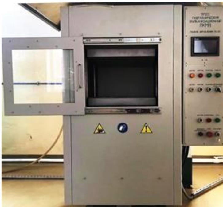
Рисунок 5 – Изображение гидравлического пресса, используемого для формовки образцов из полимерно-композиционного материала
