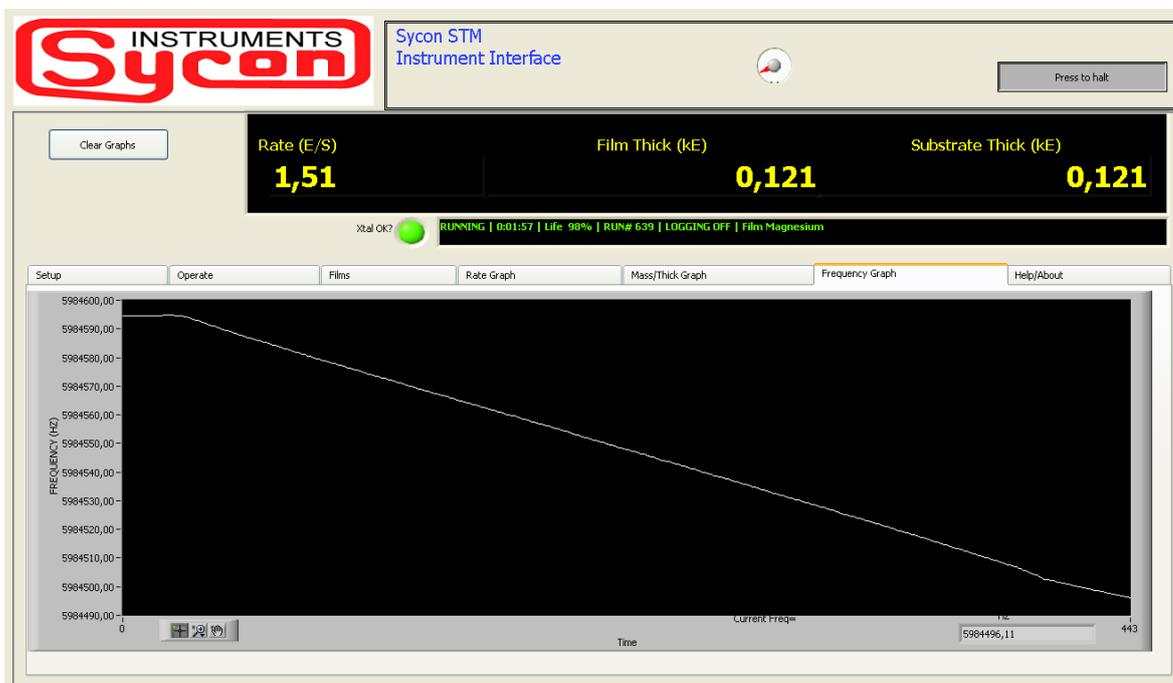
Рисунок 26 – Интерфейс программы, управляющей работой прибора Sycon Instruments
