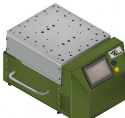
Рисунок 9 – Изображение вибростенда ВИКАМ 35/14 компании ТехноПрист [15]
