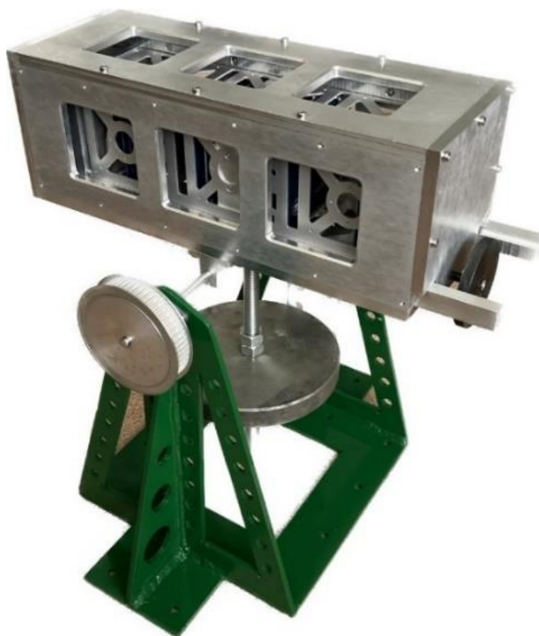
Рисунок 18 – Изображение экспериментальных образцов модернизированного ИТПК для МКА CubeSat 1U-3U, установленного на поворотное основание
