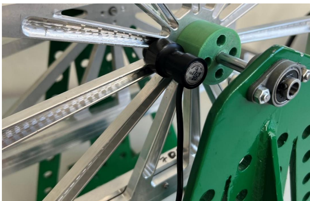
Рисунок 41 – Фотография вибродатчика закрепленного на боковой стенке ИТПК, в области крепления его полуоси
