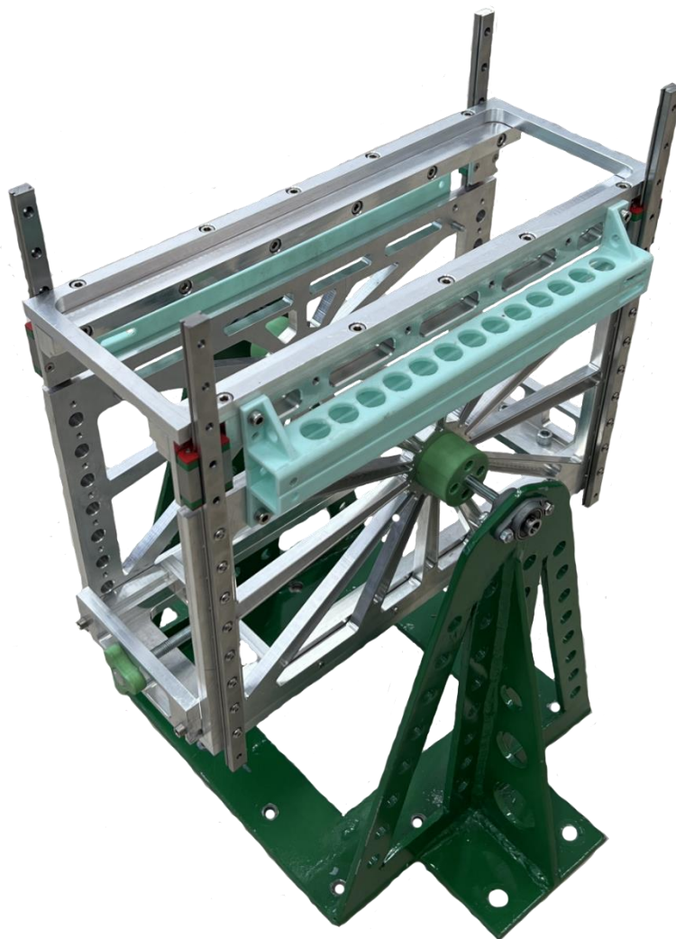
Рисунок 40 – Фотография экспериментального образца ИТПК для наноспутников стандарта CubeSat 6U, установленного на поворотное основание
