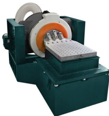
Рисунок 6 – Изображение электродинамического вибростенда Glotech 612VN [13]
