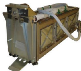
Рисунок 1 – Фотография транспортно-пускового контейнера для спутников стандарта CubeSat 3U [1]
