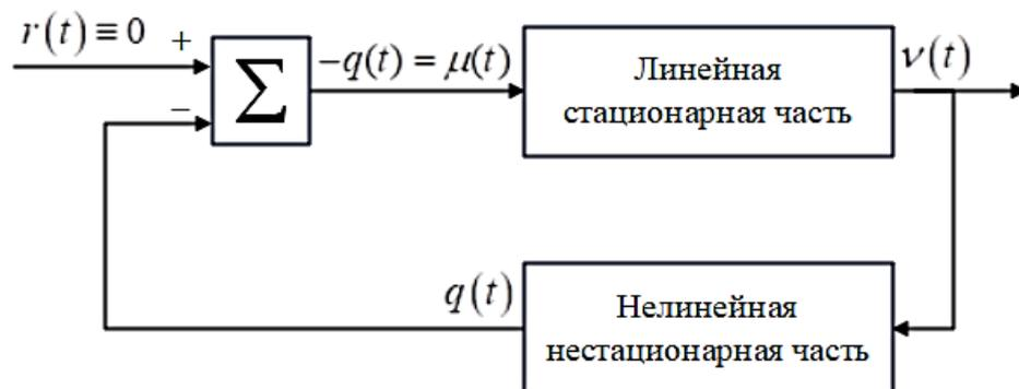
Рисунок 1 – Структурная схема системы управления при исследовании на гиперустойчивость
