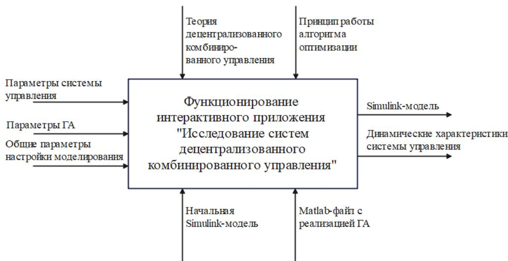
Рисунок 15 – Функциональная модель интерактивного приложения в нотации IDEF0
