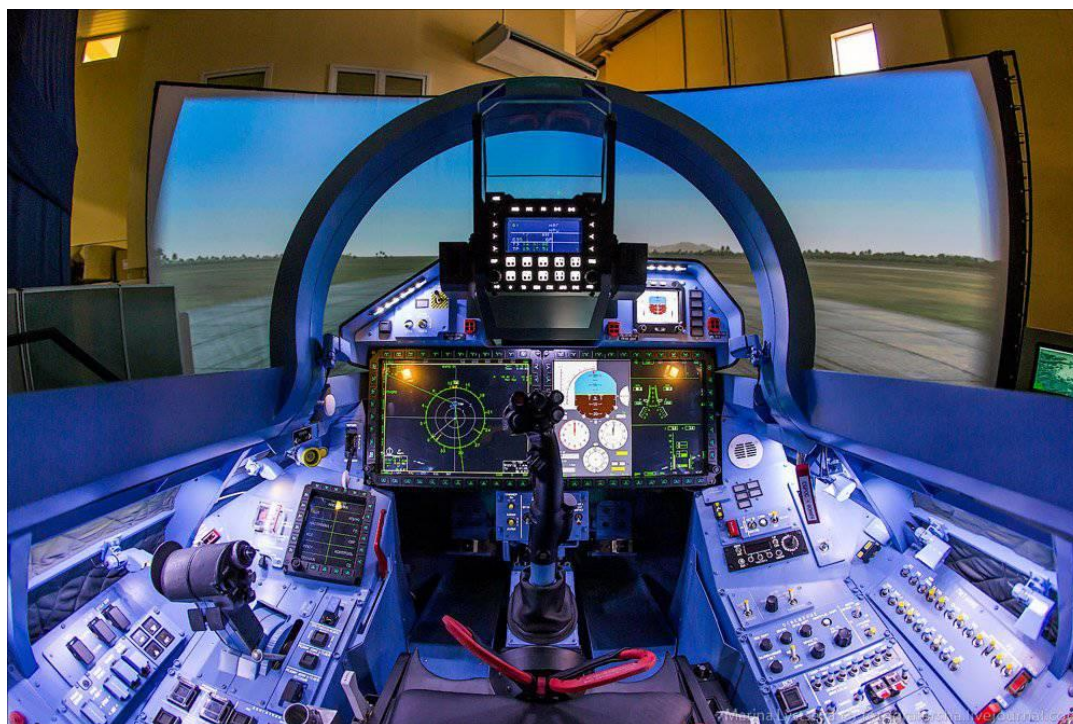
Рисунок 2 – Комплексный симулятор полёта на Су-35 с использованием полной реконструкции кабины пилота
