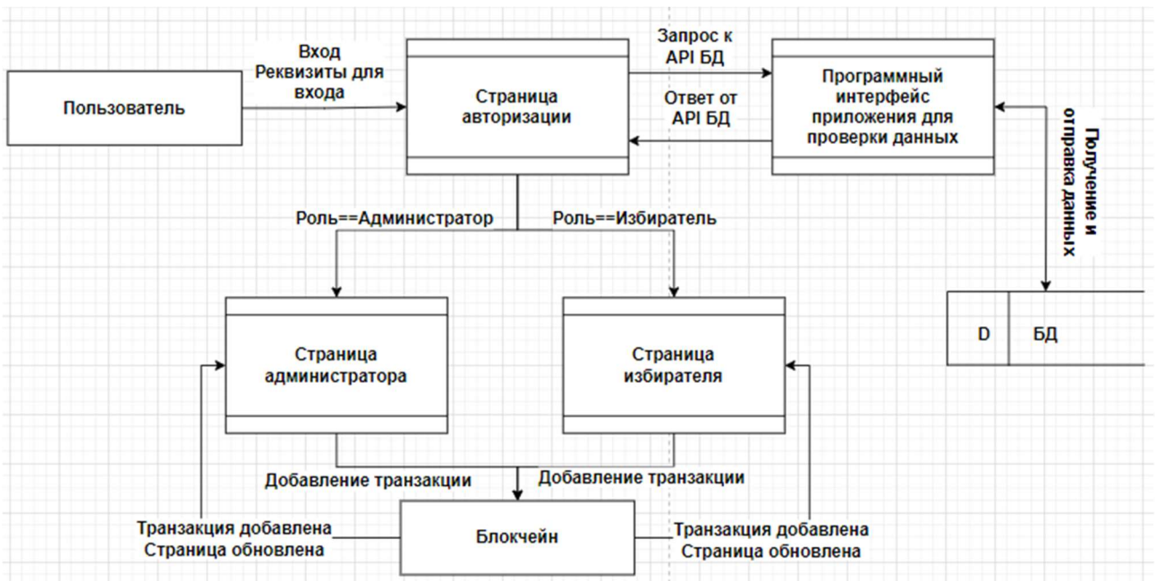
Рисунок 4 – Диаграмма DFD2 разрабатываемой системы
