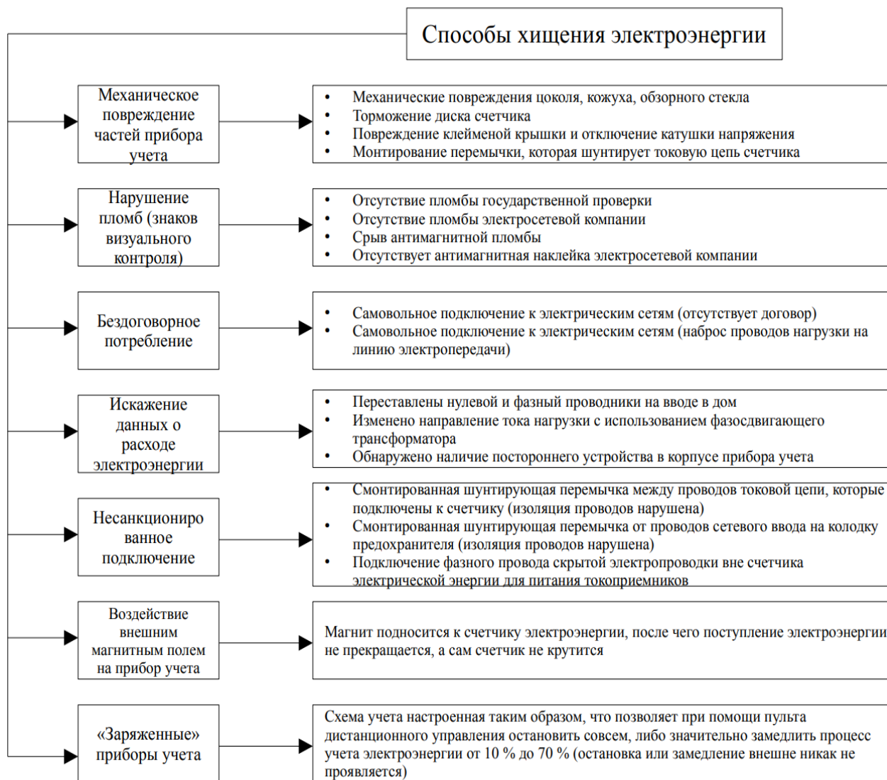
Рисунок 4 – Основные способы хищения электроэнергии
