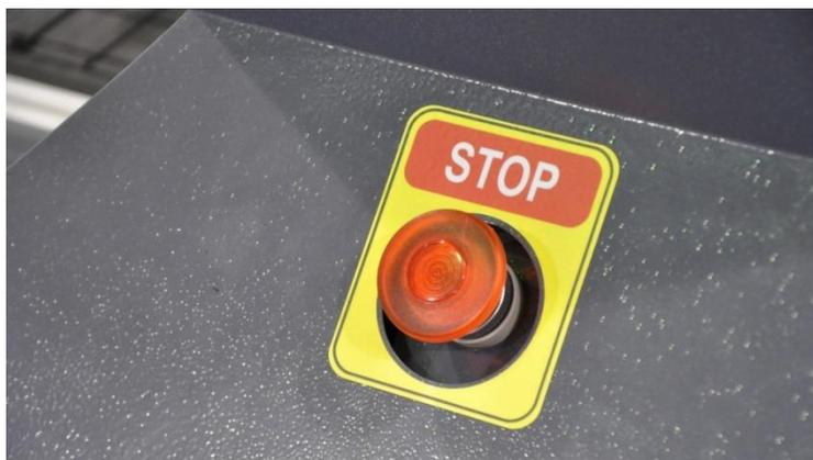
Рисунок 5.4 – Кнопка аварийного отключения станка с ЧПУ
