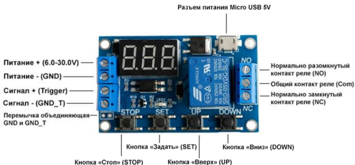
Рисунок 7 – Обозначение разъемов и кнопок реле JZ-801
