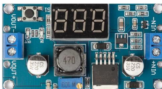
Рисунок 13 – DC-DCпреобразователь напряжения LM2596
