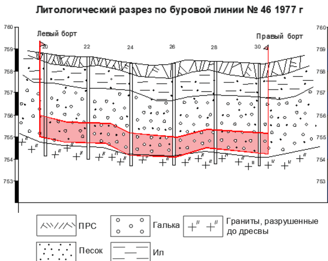
Рисунок 6 - Предполагаемый литологический разрез по объекту «Моросько», М верт. 1:100, М гор. 1:1000
