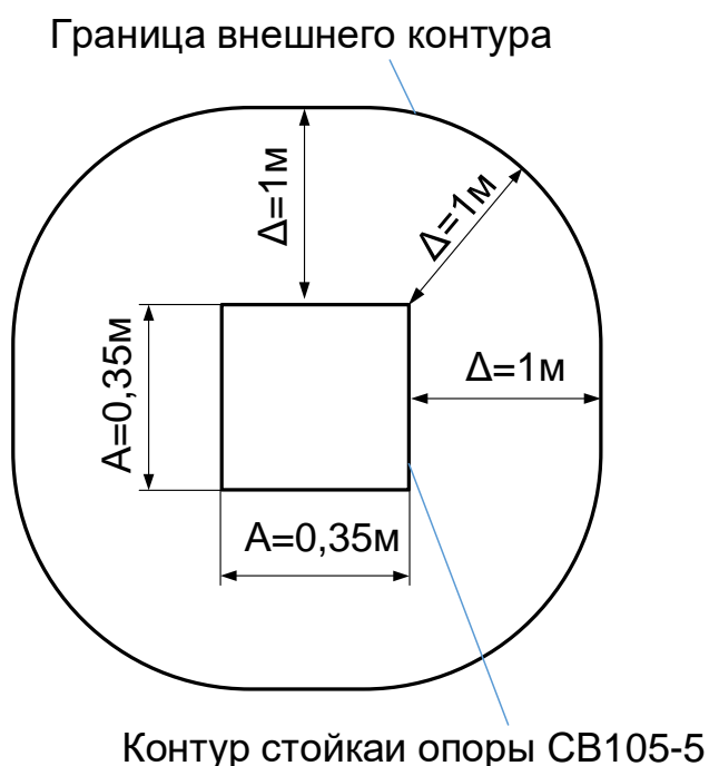
Рисунок 6 – Отвод земли в постоянное пользование под промежуточную опору П10-1 в сетях 10 кВ с центром питания ПС «Благословенное»
