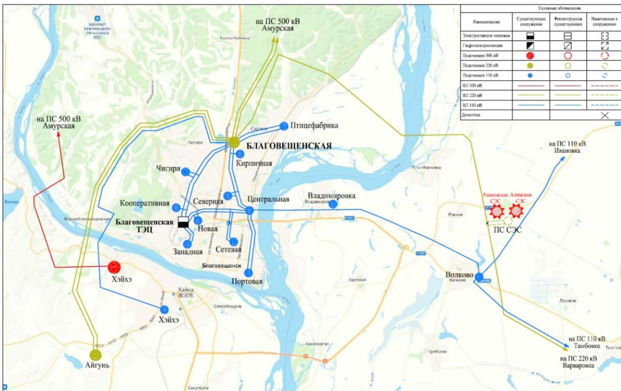
Рисунок 13 – Карта-схема электрических сетей, вариант 3
