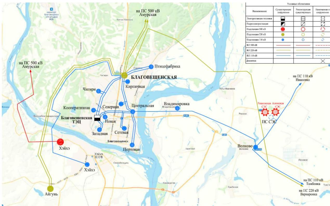
Рисунок 11 – Карта-схема электрических сетей, вариант 2
