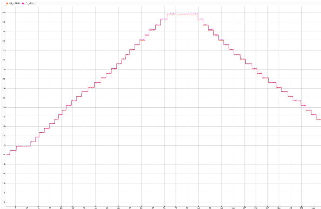
Рисунок 107 – Напряжение на вторичной обмотке реального двухобмоточного трансформатора (красная линия) и его имитационной модели (оранжевая линия)
