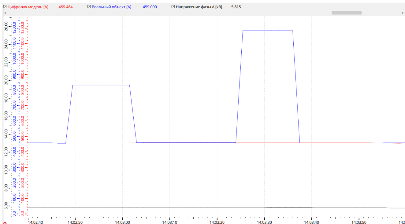
Рисунок 37 – Временной ряд токов и напряжений фазы А (синий тренд – ток реального объекта, красный тренд – ток цифровой модели, черный тренд – напряжение) при изменении тока реального объекта
