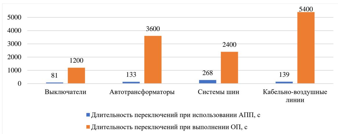
Рисунок 16 – Сравнение длительности различных типов переключений
