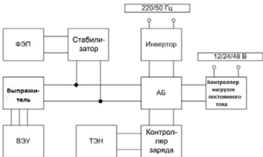
Рисунок 7 - Структурная схема ветросолнечной установки: ФЭП – фотоэлектрический преобразователь; ДЭС – дизельная электростанция; ТЭН – тепловой электронагреватель; АБ – аккумуляторная батарея
