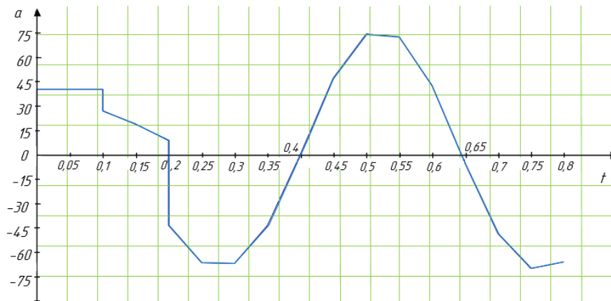
Рисунок 34 – Зависимость ускорения от времени при КЗ на линии б для третьего варианта группы коэффициентов
