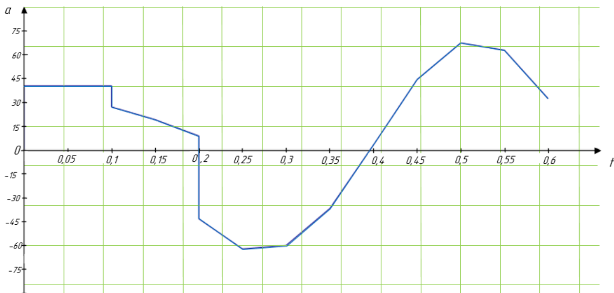
Рисунок 24 – Зависимость ускорения от времени при КЗ на линии 1
